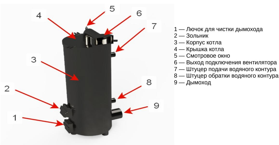
5.1. Отопитель изготовлен из стали. Толщина стали топки 5-8 мм. Толщина чаши (дна камеры сгорания) 8 мм. Толщина стали наружной части (рубашки) — 2 мм.
